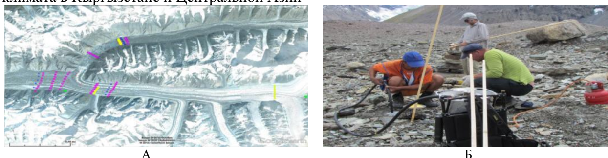
Рис. 4. А. Схема ежегодных абляционных пунктов и GPS измерений, проведение снегомерной съёмки, установка осадкомера «Третьякова»; Б. Бурение ледовых скважин паро-буром для установки абляционных рек.
