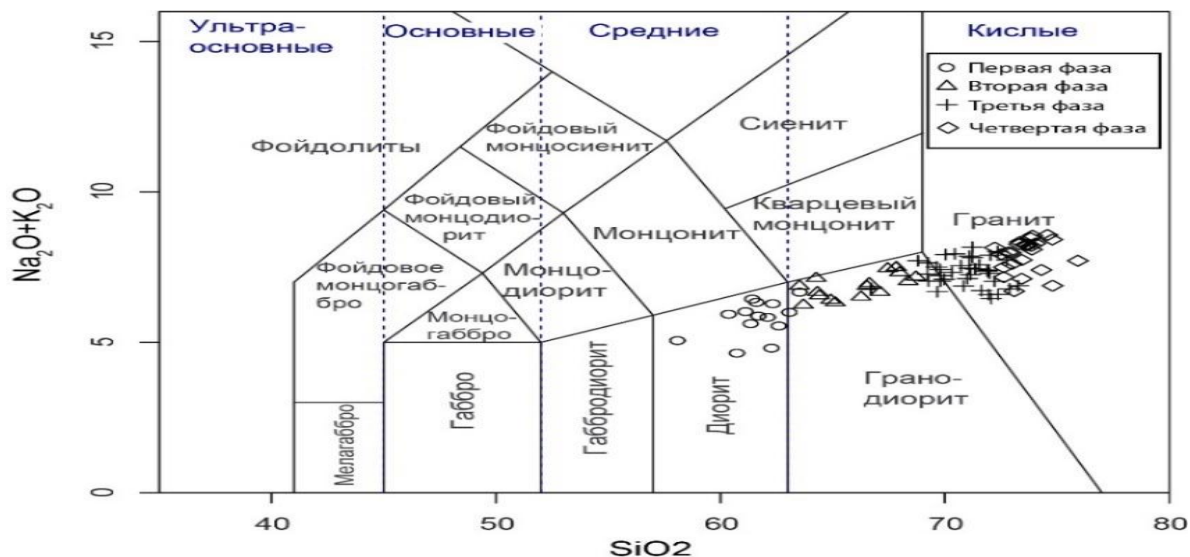
Рис. 1 Классификационная диаграмма TAS (TA-total alkali – S-silica=сумма щелочей – кремнезем, [Le Bas и др.; 1986]) для гранитоидов Каракульского комплекса
