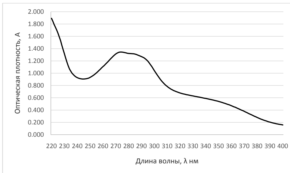
Рис. 4. УФ-спектр испытуемого спирто-водного экстракта, полученный при определении количественного содержания суммы фенольных соединений в листе Iridodictyum reticulata .
